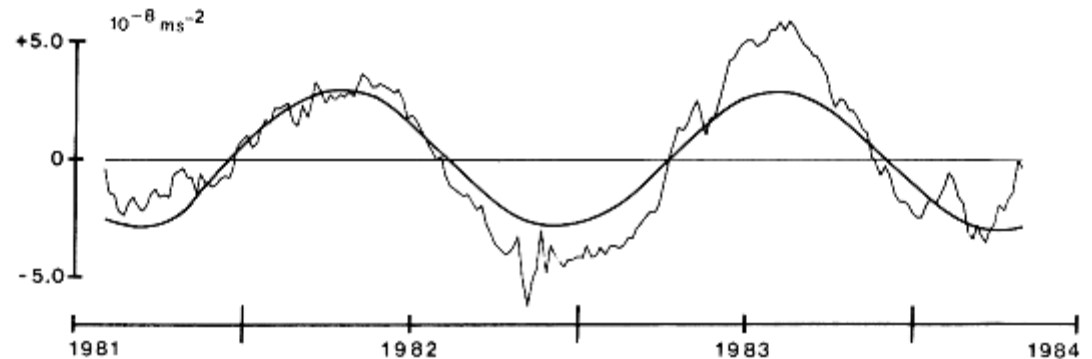
Abbildung 5.14: Vergleich der gerechneten mit der gravimetrisch beobachteten CHANDLER- Periode
